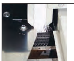
Cylindre dentelé pour l'aération des feuilles
